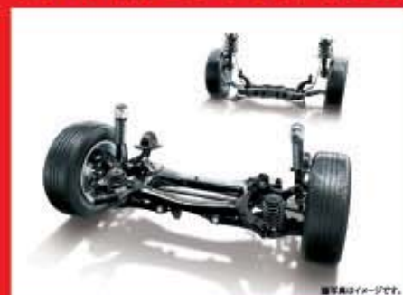
リヤサスペンションにダブルウィッシュボーン式を採用することで、振動の少ない乗り心地や軽やかなコーナリングなど、衝撃をしっかり吸収する質感に優れた走りを実現。
